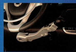
BRAKE LEVER INCLUDING INDICATORS / LIGHTS / HORN. CARBON FINISH
